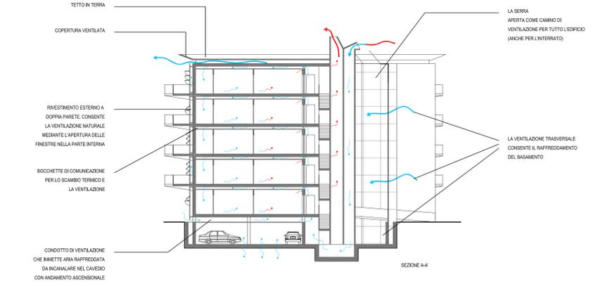
SCHEMA FUNZIONAMENTO BIOCLIMATICO - scala 1:200
