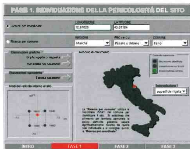
Figura 1- Spettri NTC vers 1.0.3 - definizione dei parametri sismici
