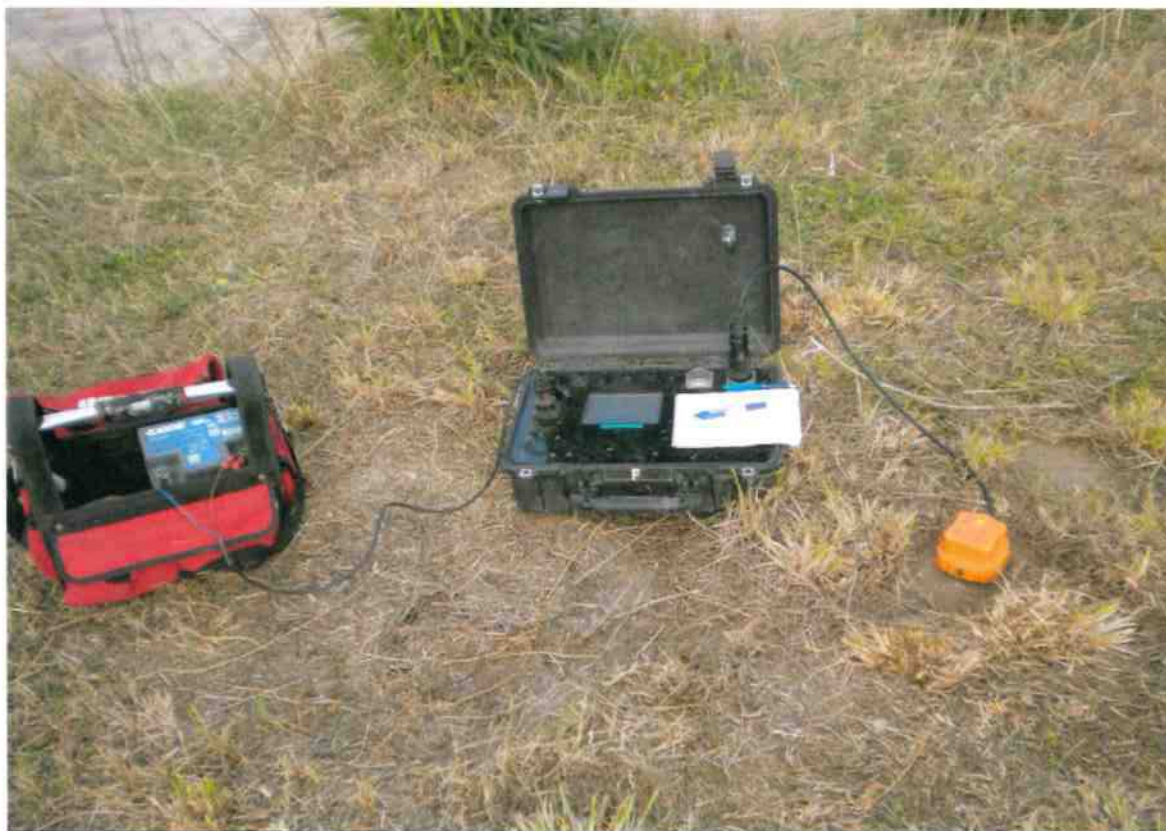
FOTO N.3 – Esecuzione prospezione sismica HVSR – Area "Ristorante Nuova Casaccia" – Loc. Roncosanbaccio – Fano (PU).
