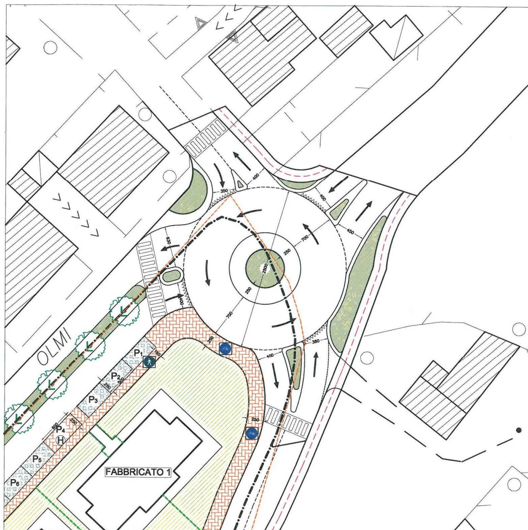
Figura 5 - Sistemazione della viabilità all'incrocio tra via degli Olmi e Via del Ponte
